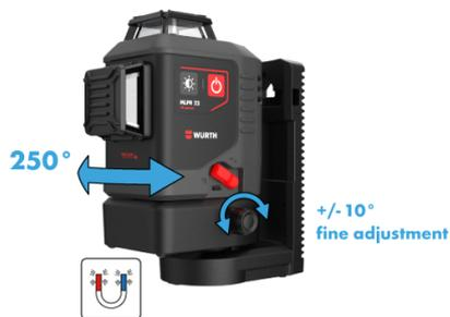
Das Gerät um 250° drehen, um die vertikale Linie auszurichten. Das seitliche Verstellrädchen verwenden und das Gerät um  $\pm 10^\circ$  um den vertikalen Kreuzungspunkt / Lotpunkt drehen.
